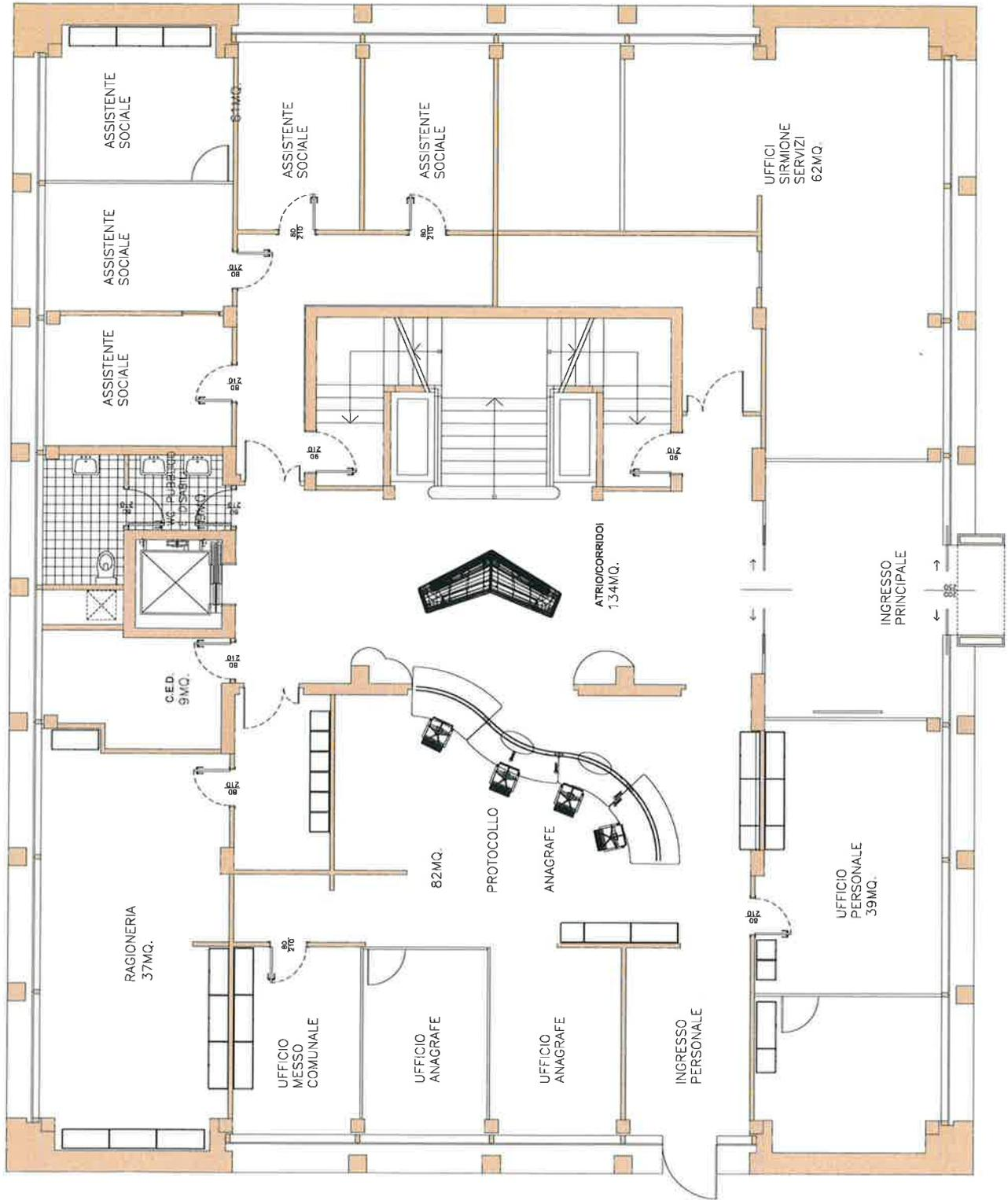
PIANTA PIANO TERRA\_INSTALLAZIONE PARETI VETRATE E COLLOCAZIONE ARREDI
